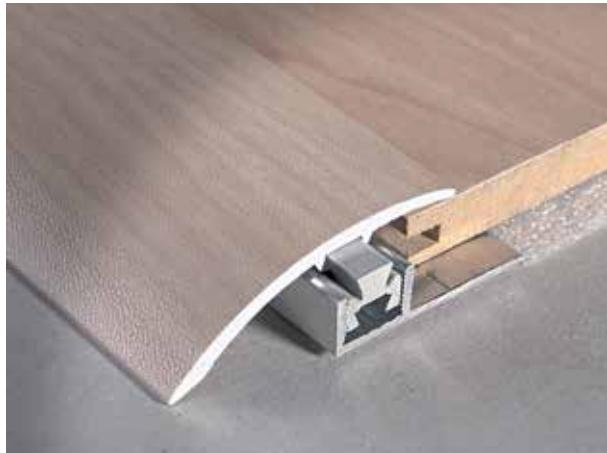
Profilé final breveté pour rattraper des dénivellations comprise entre 0 et 6 mm. Les éléments composant le système MULTICLIP se combinent parfaitement entre eux grâce au clip en plastique et garantissent un système résistant, réglable et flexible. La légère rotation du profilé de finition lui permet de s'adapter parfaitement à la dénivellation à rattraper.
